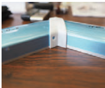
特別な角度で設計された製作途中 のマンションの手すりの一部
